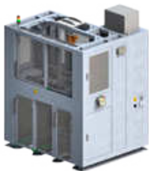
6-Achs-Roboter, 2 Ladeboxen und Messtechnik 6-axes-robot, 2 trolley boxes and measurement system
