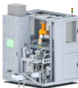
6-Achs-Roboter, 2 Ladeboxen und Messtechnik 6-axes-robot, 2 trolley boxes and measurement system
