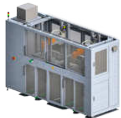
2x Scara Roboter und 4 Ladeboxen 2x Scara robot and 4 trolley boxes
